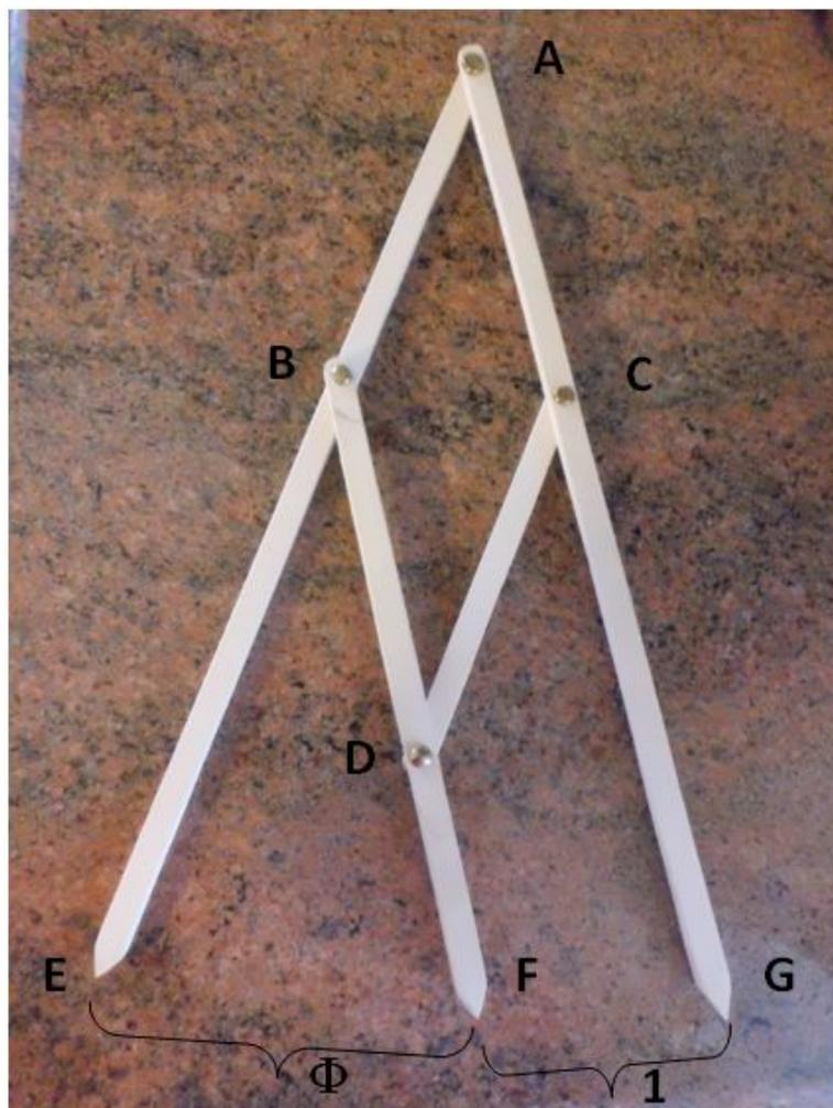
Le misure indicano le distanze tra due fori o tra un foro e una punta e non la lunghezza complessiva delle asticelle.
